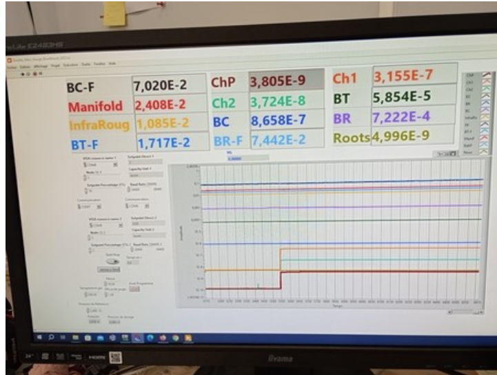
Illustration 10: Ecran de contrôle des pressions dans les différentes parties de VENUS
