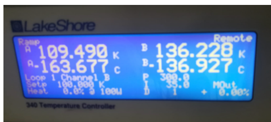
FIG 3.5 - PHOTO DU SUIVIE DE TEMPERATURE VIA LE LAKESHORE. A=TEMPERATURE INTERNE AU CRYOSTAT ET B = TEMPERATURE SUBSTRAT
